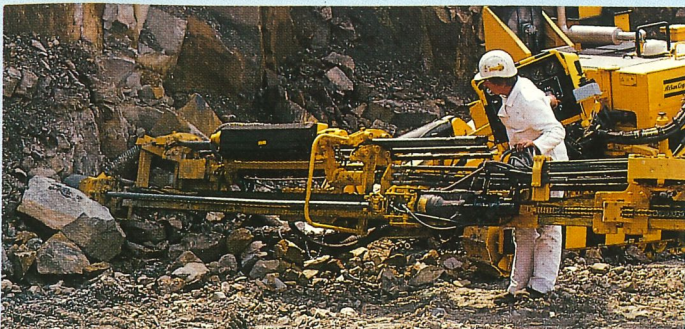
Durch Umstecken des Lafettenschwenkzylinders beim ROC 712HC lassen sich problemlos Sohlenlöcher bohren.
