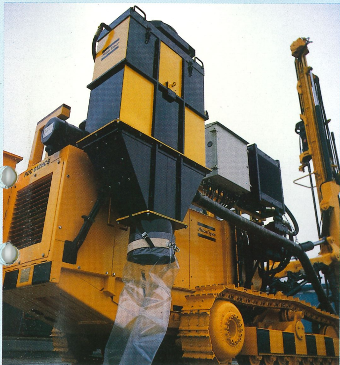
Der hydraulisch angetriebene Staubabscheider von Typ DCT sorgt für gesündere Arbeitsbedingungen beim Bohren.
