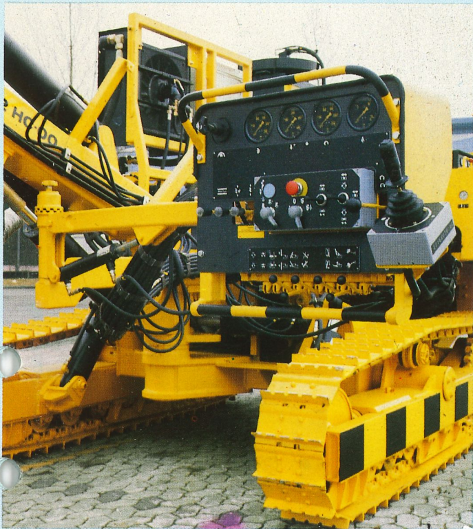
Beim ROC 712HC sind die Bohr- und Ausleger-Positionierhebel standardmäßig an der Lafette montiert.
